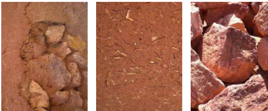
Figure 159 : Matériaux de construction utilisés à Abyaneh (adobe, paille et pierre)
