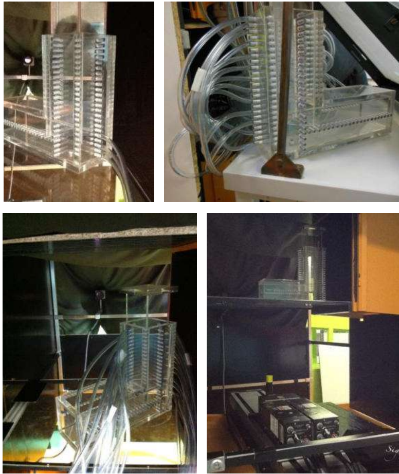
Figure 185 : Maquette installée dans la soufflerie
