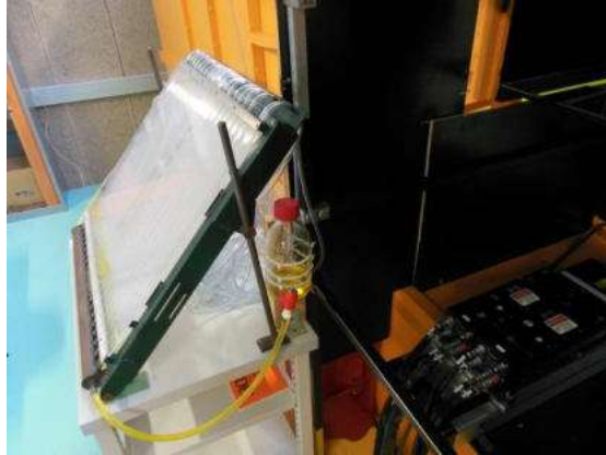
Figure 188 : Réservoir d'alcool et appareil de mesure
